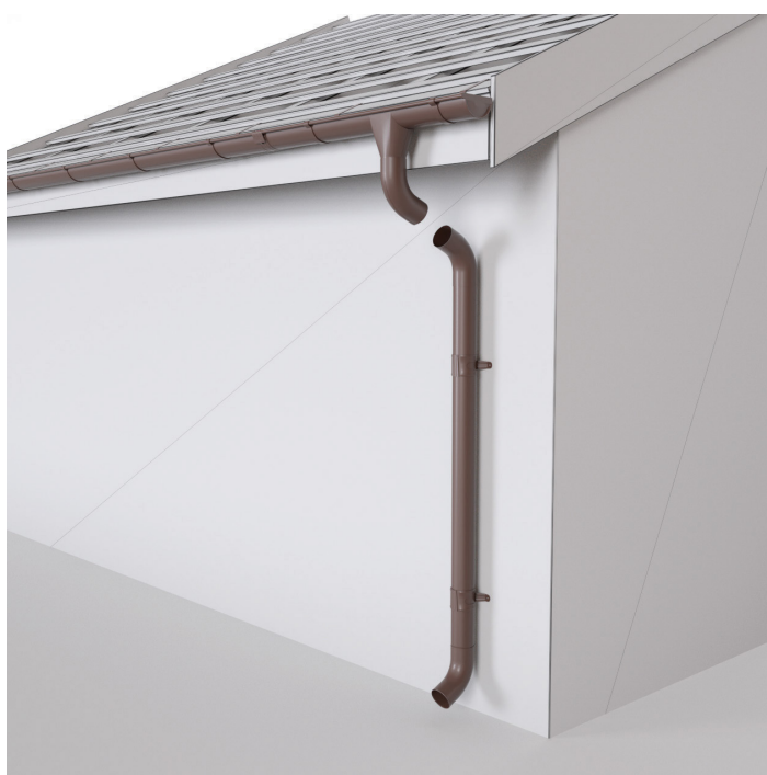
Distanța dintre brățări nu va depăși 2000 mm
