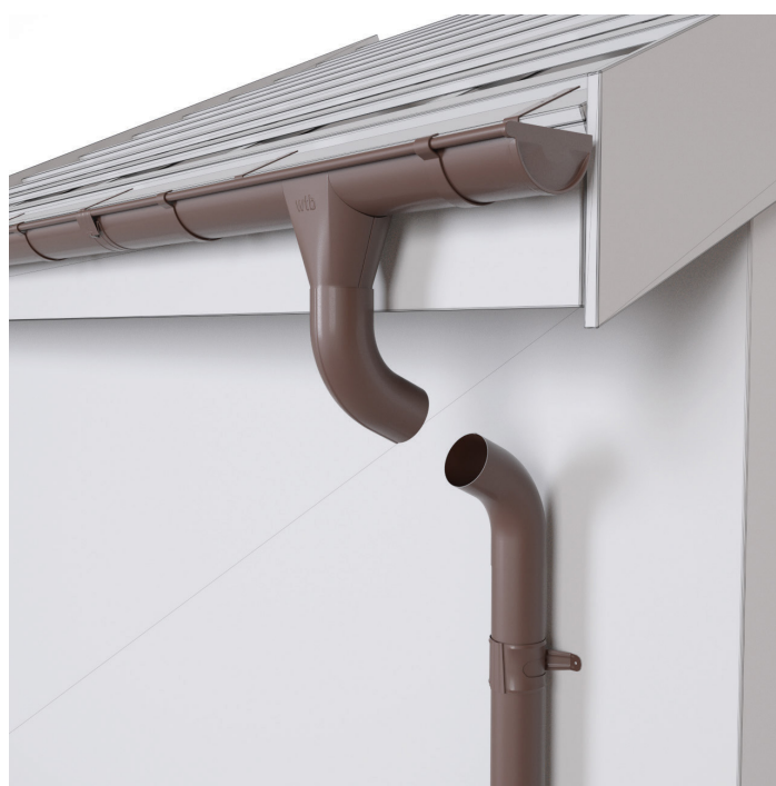
Față de cotă dintre coturi, prelungitorul de burlan se va debita cu 50 mm + 50 mm, mai mare
